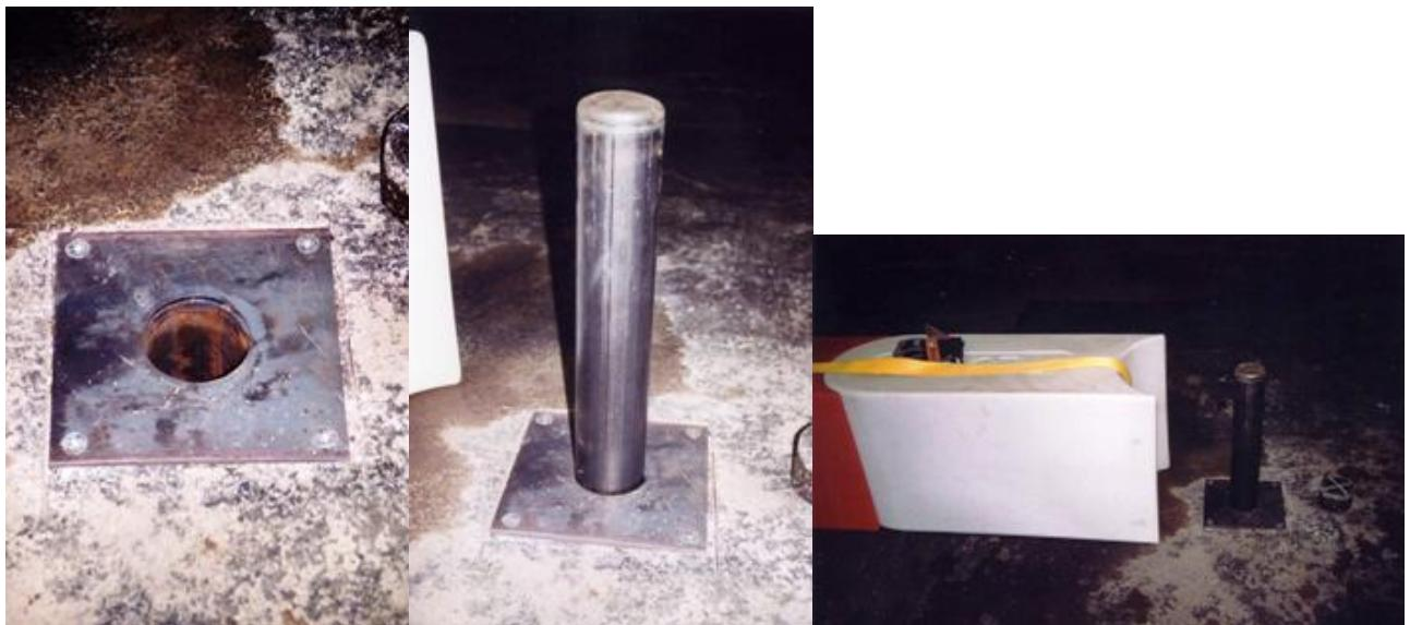
Le tube se compose de 2 parties, la partie femelle (qui rentrera dans le sol + une platine de fixation), et une partie male (qui rentrera dans la partie femelle). Cette pièce doit être fabriquée et installée par un professionnel.
